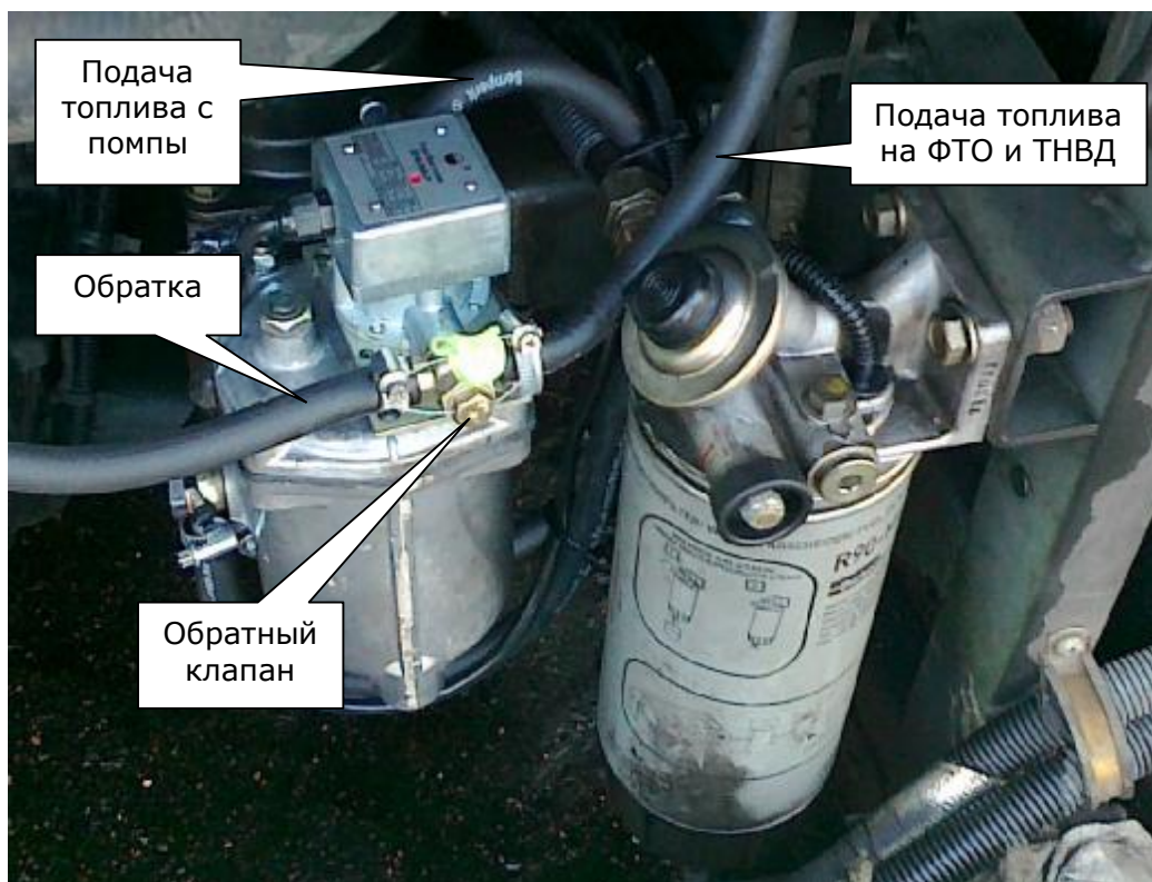
Рис. 11 Схема установки DFM на разрежение без деаэратора на двигателе Mercedes
