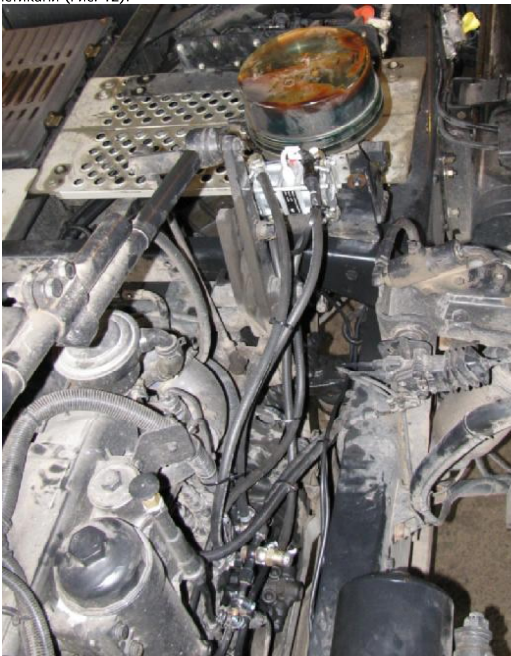
Рис. 12 Установка DFM по дифференциальной схеме на двигателе MAN
