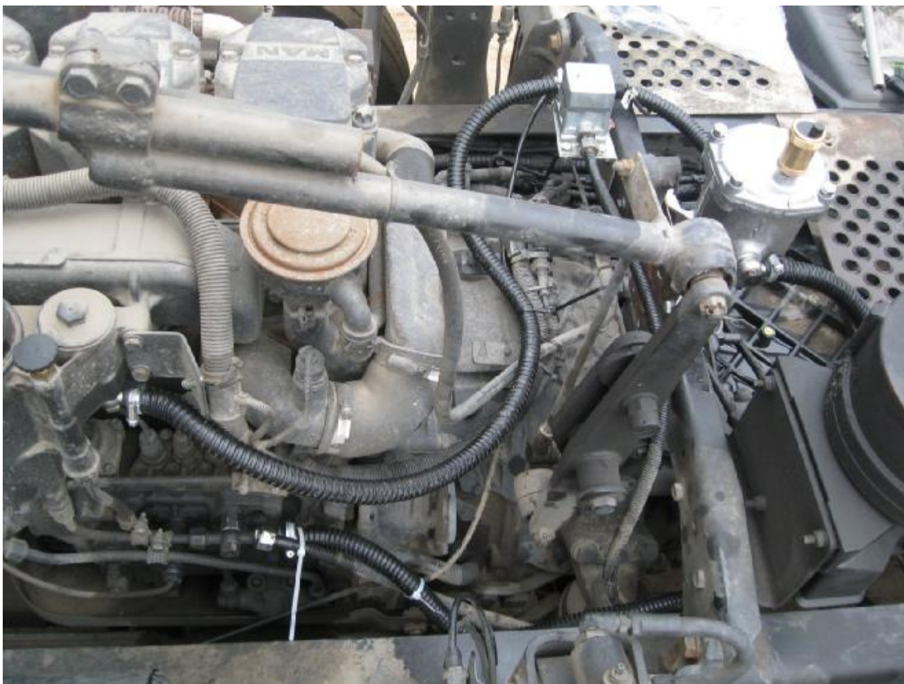
Рис. 8 Схема установки DFM на разрежение с деаэратором на двигатель MAN
